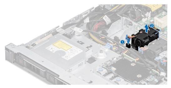
Figure 23. Removing a cooling fan
