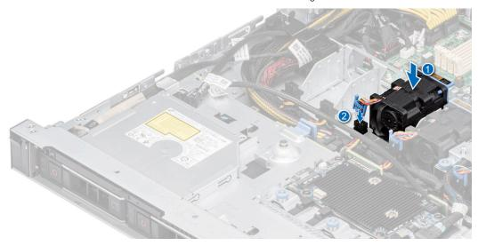
Figure 24. Installing a cooling fan
