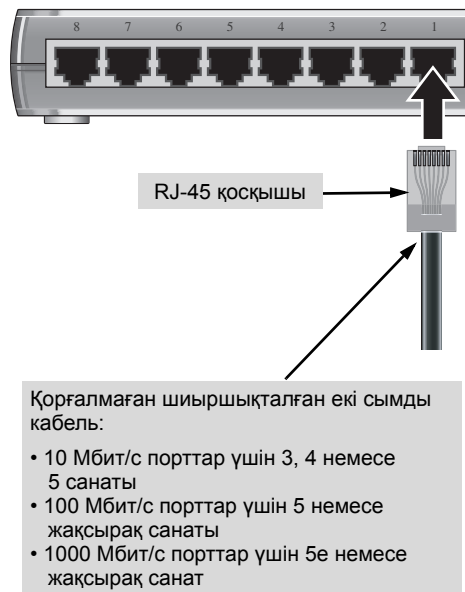
2-5. сурет Желі кабельдерін қосу
